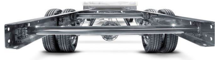
Karosserie in Leiterrahmenbauweise (Body-on-frame)
